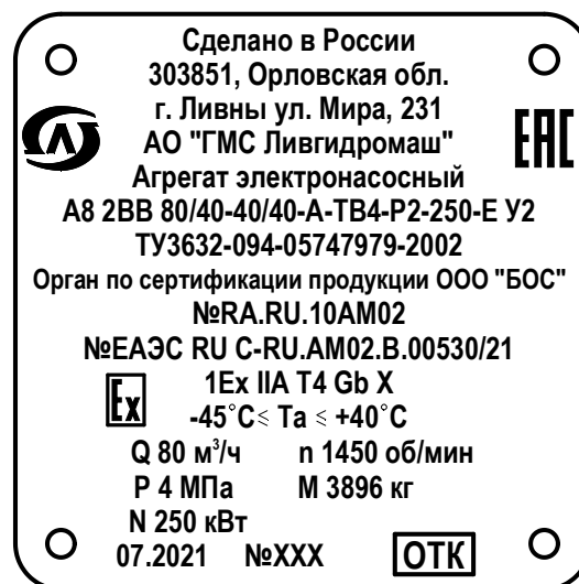
Рисунок 3 – Фирменная табличка (пример оформления)
